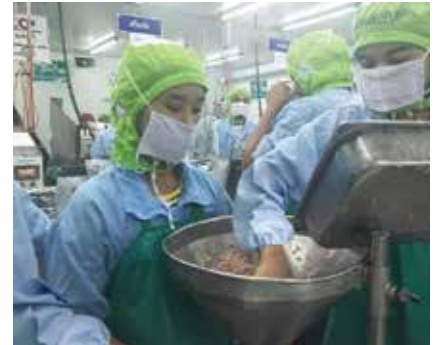
11 パウチへフレークの投入、調味液の注液
